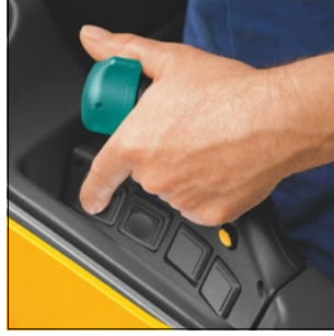
ESD 120: Ayarlanabilir hız ve kaldırma fonksiyonu için kumanda elemanı
