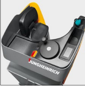
İyi erişilebilir kumanda elemanlarına ve katlanabilir koltuğa sahip standart cihaz ESE 120
