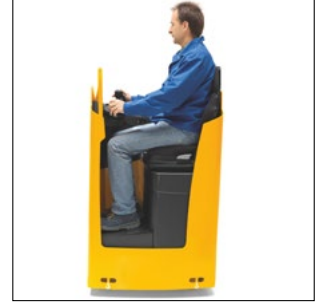
ESE 220/320'de yükseklik ayarı yapılabilen zemin plakasına sahip konforlu oturma pozisyonu
